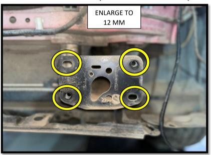
REMOVE THE NUTS FROM THE BACK OF THE FLANGE
